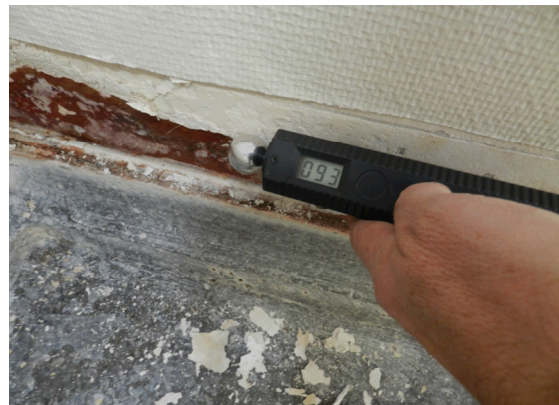
Vester 4-11, C-bolig – Opfugtning bag PVC-listen
