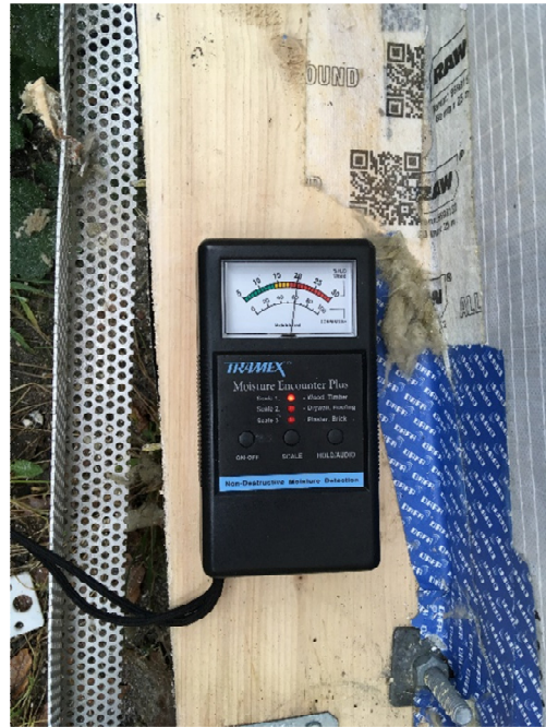
Fugtmåling på ny bundrem – lettere opfugtet men ikke alarmerende den generelle fugtighed taget i betragtning.
