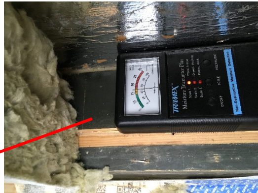
Fugtmåling på ny bundrem – lettere opfugtet men ikke alarmerende den generelle fugtighed taget i betragtning.
